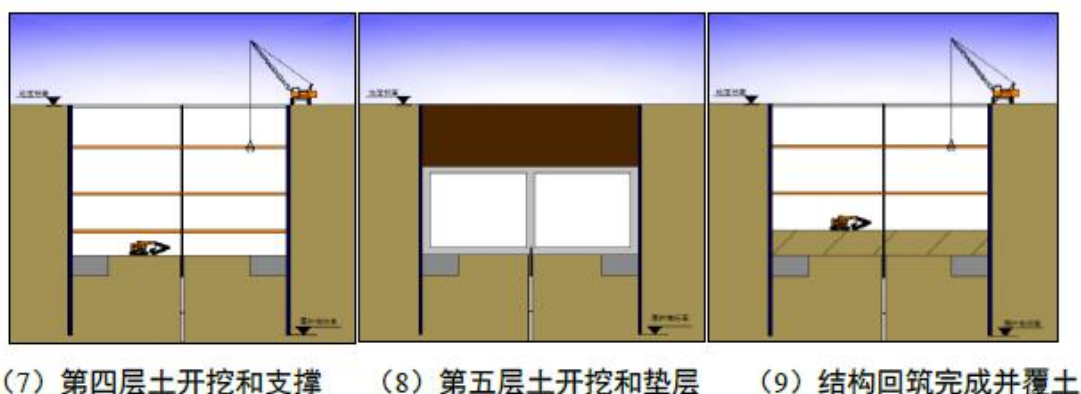
图 3-8 基坑施工流程图
