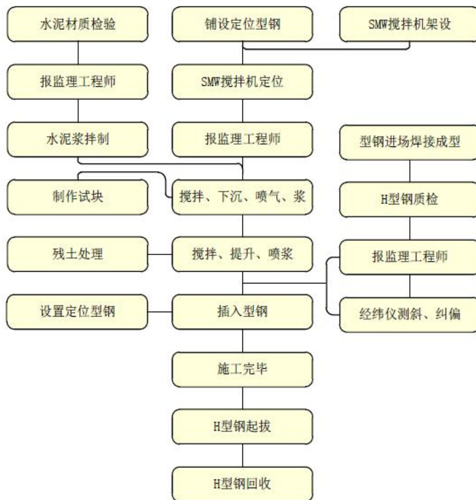
图 3-6 SMW 工法桩施工流程
